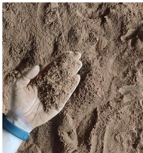
Figura 6 - Lodo destorroado. A imagem mostra uma mão segurando uma quantidade de material granular seco e amarelado, com uma textura mais homogênea e sem grumos visíveis.
