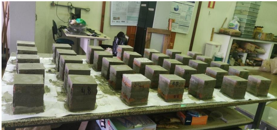
Figura 13 - Preparação dos tijolos para ensaio de resistência à compressão.
